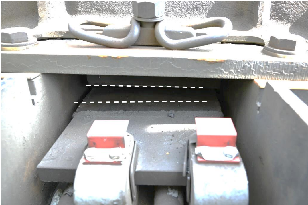
Bilden visar bottenplåten i drivanslutningsplattan som lossnat från vinklarna upp till korsningsspetsen. En av de brustna svetsfogarna framgår där den övre och nedre delen är markerade med vita streckade linjer. Drag- och kontrollstängerna från växeldrivet är synliga i bildens nederkant.
